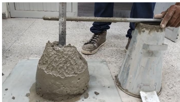
Figura 02: Abatimento do tronco de cone
