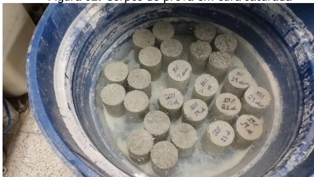
Figura 02: Corpos de prova em cura saturada
