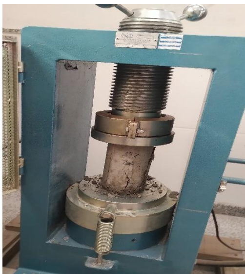
Figura 03: Corpo de prova rompido
