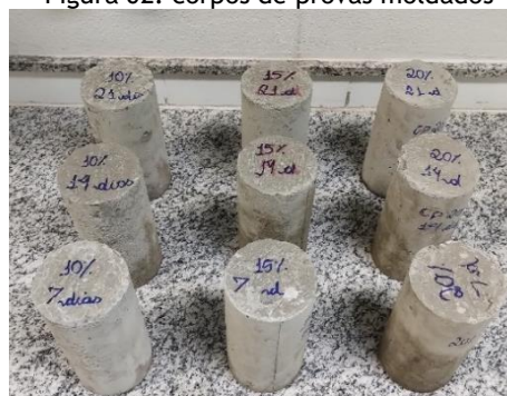
Figura 02: corpos de provas moldados
